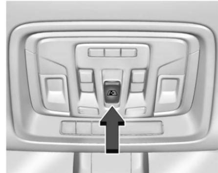
Si está equipado, la ventana trasera eléctrica funciona cuando la ignición está encendida o en modo de accesorios, o la Energía retenida
