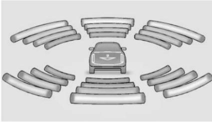
El grupo de instrumentos puede tener una pantalla de Asistencia de estacionamiento con barras que muestran la "distancia al objeto" e información de ubicación de objeto para el sistema de Asistencia de estacionamiento delantero y trasero. Conforme el objeto se acerca, se iluminan más barras y las barras cambian de color de amarillo a ámbar a rojo.
