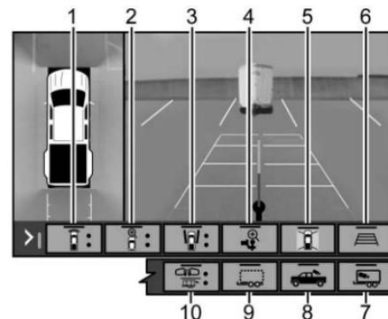
Algunas vistas pueden mostrarse automáticamente, o cambiar basándose en el movimiento del vehículo o funciones adicionales de seguridad. Para vistas que utilizan un botón compartido, toque el botón para cambiar entre ellas.
