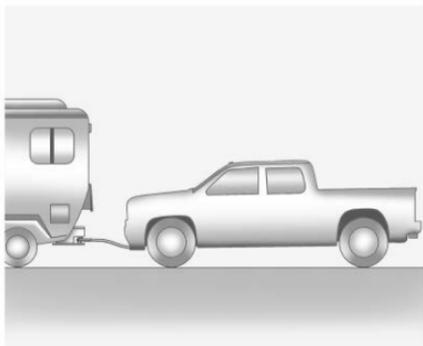
Solo remolque en plataforma vehículos con tracción en las cuatro ruedas que cuenten con caja de transferencia de dos velocidades y tengan la configuración N (neutral) y 4 ↓ (tracción en las cuatro ruedas baja).
