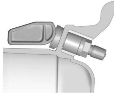
Póngase en contacto con el centro de servicio de su remolque o con el centro de servicio de llantas para instalar los sensores de presión dentro de las llantas del remolque. El técnico debe insertar el vástago del sensor a través del orificio en la rueda del remolque. Cuando el sensor está colocado correctamente, la tuerca en el vástago del sensor debe apretarse a 8N•m (6 lbs pie). Al montar la llanta del remolque en la rueda del remolque, tenga cuidado de no dañar el sensor.
