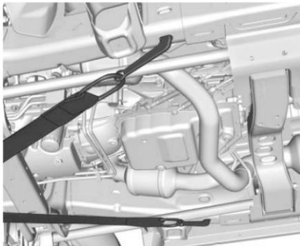
El vehículo está equipado con puntos de conexión específicos que se usarán para jalar el vehículo sobre una grúa de plataforma plana
