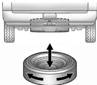
Se muestra con el lado de vástago de la válvula hacia abajo
