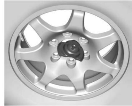
**Todos los demás modelos guardados incorrectamente, retenedor descentrado**
