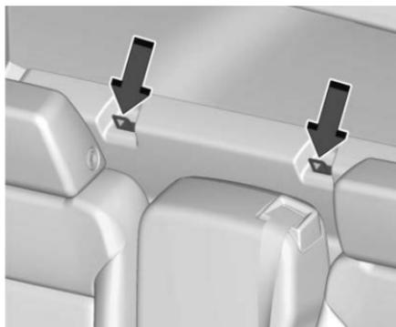
Los anclajes de atadura superior están en el tablero trasero, detrás del/los asiento(s) del pasajero o del asiento central. Asegúrese de utilizar el anclaje directamente detrás de la posición de asiento en la que se colocará el asiento de seguridad para niños.
