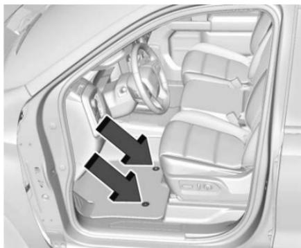
Vuelva a colocarlo alineando las aberturas del retén del tapete/revestimiento sobre los retenes de la alfombra y presione el tapete para conectarse en su posición.
