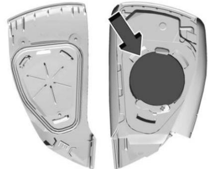
3. Retire la cubierta de la batería.
