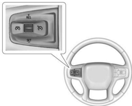
: Presione para encender o apagar el control de velocidad constante. Una luz indicadora de color blanco se enciende en el tablero de instrumentos cuando el control de velocidad constante está encendido. Consulte *Luz de control de velocidad constante* ⇨ 127.
