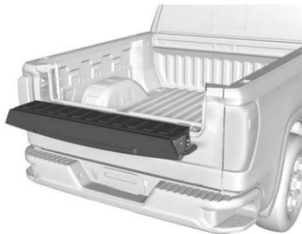
Para abrir la puerta trasera interior, presione la almohadilla táctil superior en la manija de la puerta trasera después de desbloquear todas las puertas. Jale la parte superior de la puerta trasera para abrir.
