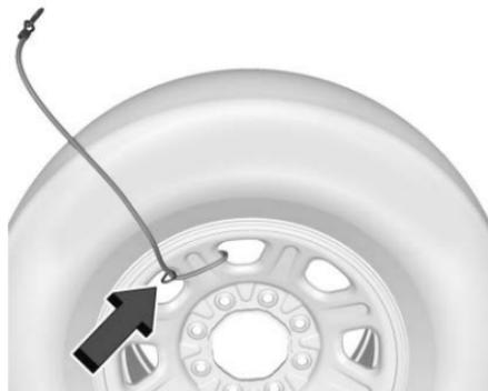
Se muestra el lado de vástago de la válvula
