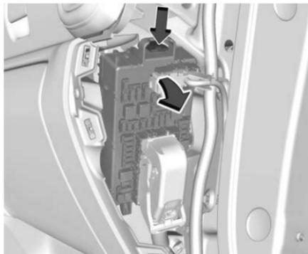
1. Empuje la lengüeta en la parte superior del bloque de fusibles hacia abajo.
