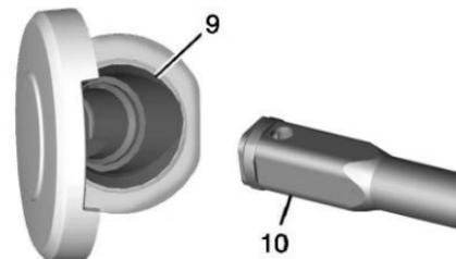
5. Inserte el extremo de elevación (10) a través del orificio (9) de la defensa trasera y en la flecha del elevador.
