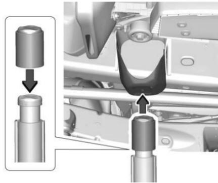
Si el vehículo está equipado con un adaptador de cabeza de elevación del gato (6), ajuste el adaptador sobre el extremo de la cabeza de elevación del gato. El adaptador debe tener un ajuste estrecho. Verifique que el adaptador y la cabeza de elevación se ajusten correctamente, después coloque el gato debajo del soporte colocado al marco del vehículo, detrás de la llanta pinchada, como se muestra.
