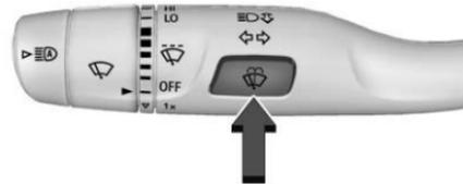
Si está equipado, presione
