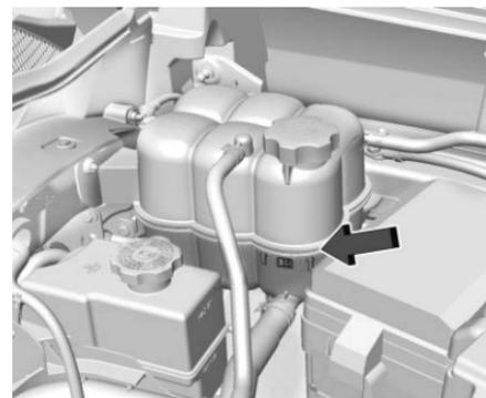
Revise si se alcanza a ver refrigerante en el tanque de compensación del refrigerante. Si el refrigerante que está dentro del tanque de compensación del refrigerante está hirviendo, espere hasta que se enfríe. El nivel del refrigerante debe estar en la marca indicada o arriba de ella. De no ser así, podría haber una fuga en el sistema de enfriamiento.
