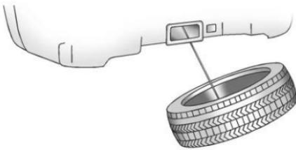
7. Incline la llanta hacia el vehículo dejando algo flojo el cable, para tener acceso al retenedor de la llanta/rueda.
