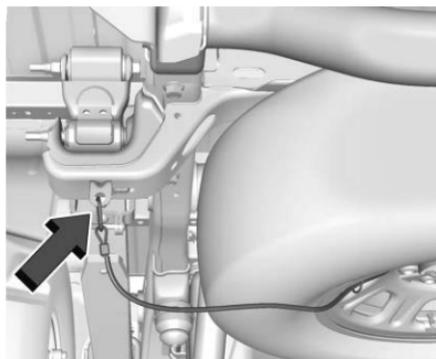
Si está equipado con un cable de llanta de refacción, vuelva a colocar el broche en el soporte del accesorio del bastidor. Tenga en cuenta que puede haber holgura en el cable.
