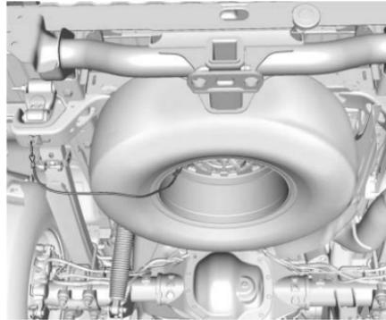
**Modelo ZR2 únicamente con el lado del vástago de la válvula hacia arriba**
