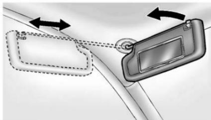
Las viseras del conductor y del pasajero se pueden jalar hacia abajo para bloquear el deslumbramiento. Si está equipado, desconecte las viseras del montaje central para girar a la ventana lateral o para extenderlo a lo largo de la varilla.
