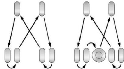
Use este patrón de rotación al hacer rotación de los neumáticos si el vehículo tiene ruedas traseras duales (excepto ruedas de aluminio forjadas pulidas).
