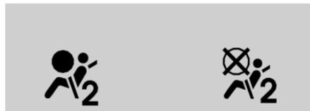
Los símbolos del indicador de estado de la bolsa de aire del pasajero se iluminarán por varios segundos como una verificación del sistema. Entonces, después de varios segundos más, el indicador de estado se iluminará para indicarle el estado de la bolsa de aire delantera del pasajero externo delantero. Vea *Indicador de estado de bolsa de aire del pasajero* ⇨ 117.
