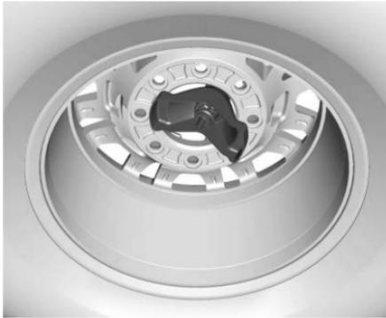
**Modelo ZR2 guardado incorrectamente, retenedor descentrado**
