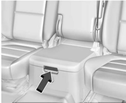
Si está equipado con almacenamiento del asiento central delantero, desbloquee con la llave mecánica de la llave remota, presione el seguro, y levante para abrir. Vea *Llaves* ⇨ 10.
