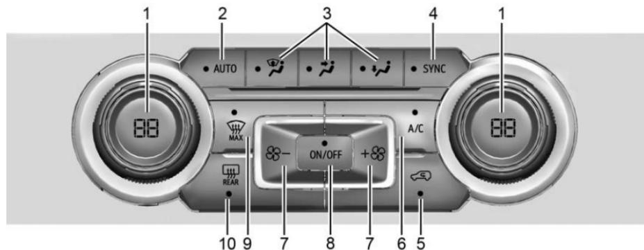
1. Controles de temperatura del lado del pasajero y del conductor
