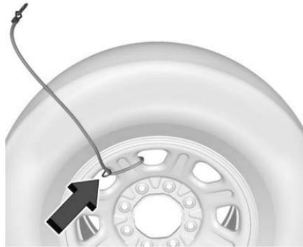
9. Si está equipado con un cable de llanta de refacción, retire el cable de la llanta de refacción pasando el broche a través del extremo enrollado del cable.
