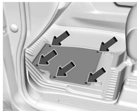
Vuelva a instalar alineando los sujetadores de botón del inserto del revestimiento de piso sobre los retenedores de revestimiento y conectándolos en posición.
