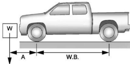
$(W \times (A + W.B.)) / W.B.$  = Peso que está agregando el accesorio al eje frontal.
