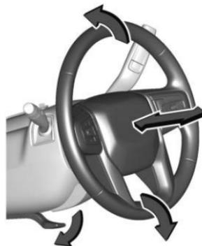
Para ajustar el volante telescópico y con inclinación, si está instalado:
