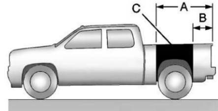
Utilice el borde trasero del piso de carga con fines de medición. La ubicación recomendada para el centro de gravedad de la carga es en la zona C para la CWR. Éste es el punto donde la masa de la carrocería se concentra y, si se suspende en ese punto, se equilibraría la parte delantera y la parte trasera.
