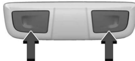
Oprima las lentes de la lámpara para encender o apagar las luces de lectura traseras.
