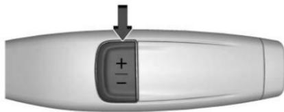
El Modo de selección de rango ayuda a controlar la transmisión del vehículo y la velocidad del vehículo mientras conduce cuesta abajo o transporta un remolque. Permite la selección manual de un rango de velocidad deseado.
