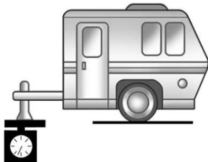
La GVWR incluye el peso en vacío de su vehículo, cualquier pasajero, carga, equipo y el peso de la lengüeta del remolque. Las opciones del vehículo, pasajeros, carga y equipo reducen el peso de lengüeta máximo permisible que puede transportar el vehículo, que también reduce el peso máximo permisible del remolque.
