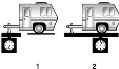
El peso de la lengüeta del remolque (1) debe ser 10-15% y el peso de lengüeta de la quinta rueda o cuello de ganso debe ser 15-25% del peso total del remolque cargado (2). Algunos tipos de remolques específicos, como remolques de bote, están fuera de estos rangos. Siempre consulte el manual de propietario del remolque para el peso de lengüeta de remolque recomendado para cada remolque. Nunca exceda las cargas máximas para el vehículo, enganche, y remolque.
