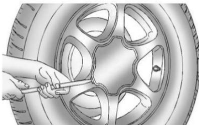
Si la rueda tiene un tapón central liso, acceso oculto a los birlos, coloque el extremo de cincel de la llave para las ruedas en la ranura de la rueda y haga palanca suavemente para sacarlo.
