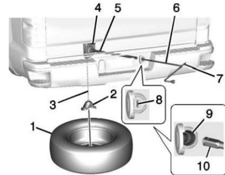
1. Llanta de refacción (Se muestra con el lado de la válvula hacia abajo)
