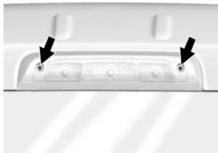
1. Retire los dos tornillos y levante el ensamble de luz para sacarlo.
