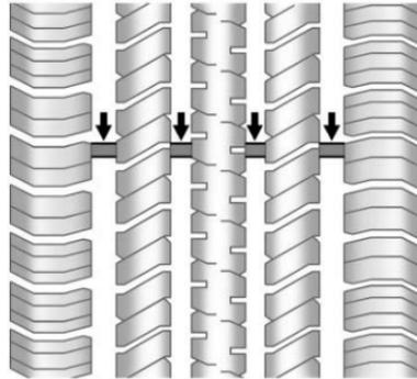
Los indicadores de desgaste del dibujo son una de las maneras de decidir cuándo es el momento para nuevas llantas. Los indicadores de desgaste aparecen cuando las llantas tienen solamente 1.6 mm (1/16 de pulgada) de dibujo remanente. Vea *Inspección de llantas* ⇨ 390 y *Rotación de la llanta* ⇨ 391.
