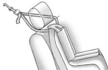
Si la posición que usa tiene un soporte de cabeza ajustable y está utilizando un amarre dual, dirija el amarre alrededor del soporte de cabeza ajustable.
