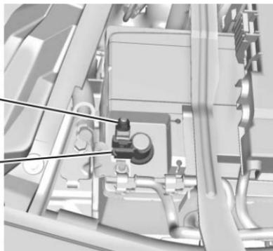
1. Afloje la tuerca del cable negativo de la batería (1).
