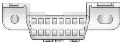
El DLC está debajo del tablero de instrumentos del lado izquierdo del volante. Conectar dispositivos que no se utilicen para realizar una Inspección de emisiones/Prueba de mantenimiento o para dar servicio al vehículo puede afectar la operación del vehículo. Vea *Equipo eléctrico incorporado* ⇨ 330. Visite a su distribuidor si necesita asistencia.
