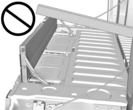
No coloque una carga en la parte superior del escalón cuando lo use como un tope de carga.
