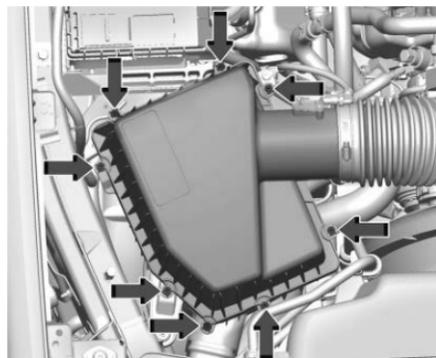
1. Localice el ensamble del depurador/filtro de aire. Vea *Vista general del compartimento del motor* ⇨ 338.
