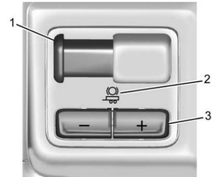
1. Palanca para aplicar el freno manual del remolque
