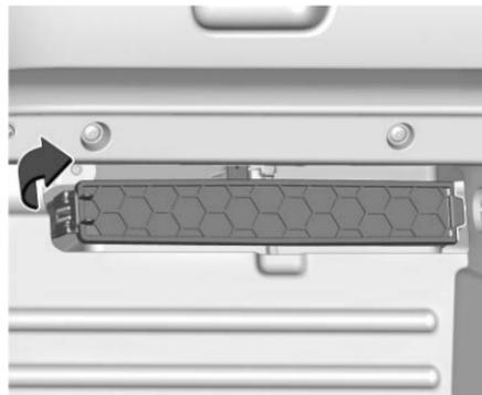
4. Jale la palanca en el lado izquierdo de la puerta de filtro y deslice a la izquierda, y después retire la puerta. Retire el filtro anterior.
