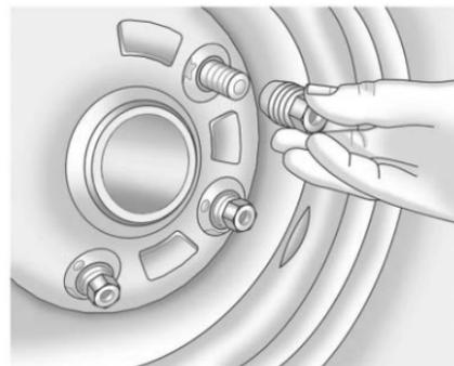
7. Retire todas las tuercas de la rueda y desmonte la llanta pinchada.
