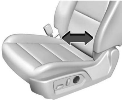
Si está equipado, oprima sin soltar la parte delantera o trasera del control para aumentar o disminuir el soporte lumbar.
