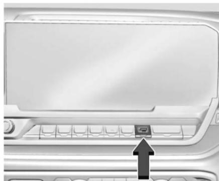
Para vehículos sin Control de Modo de Conductor, presione el botón Tow/Haul (Remolque/Transporte) en la columna central. Si está equipado con Asistencia hidráulica activa, el vehículo proporcionará una respuesta de dirección más rígida cuando el Modo Remolque/Transporte esté conectado para proporcionar funcionalidad de dirección mejorada.
