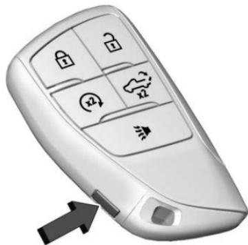
**(x2)** : El motor puede arrancarse desde el exterior del vehículo utilizando la llave remota. Presione **(x2)** dos veces. Consulte *Arranque remoto* ⇨ 18.
