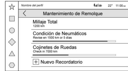
Toque para ver una lista de recordatorios de mantenimiento para el perfil del remolque.
